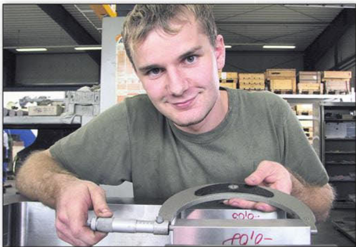
Daniel Zöllner lernt Werkzeugmechaniker. In seiner Ausbildung muss er einzelne Bauteile genau ausmessen – ein wichtiger Arbeitsschritt in der Werkzeugherstellung. F.: Rosenkranz
